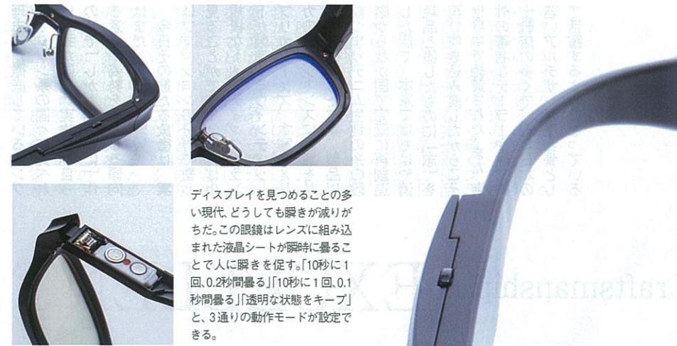
ディスプレイを見つめることの多い現代、どうしても瞬きが減りがちだ。この眼鏡はレンズに組み込まれた液晶シートが瞬時に曇ることで人に瞬きを促す。「10秒に1回、0.2秒間曇る」「10秒に1回、0.1秒間曇る」「透明な状態をキープ」と、3通りの動作モードが設定できる。
